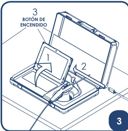
Abra la pantalla de la tablet en el ángulo deseado (1), conecte el sistema LumenEye® X1 al puerto USB (2), presione el botón de encendido (3) y consulte las instrucciones del software CHiP en «IFU-401». (Nota: la tablet se controla por medio de un interfaz de pantalla táctil. Utilice el teclado integrado para escribir).
