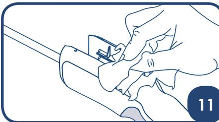
Limpie el dispositivo por completo, incluyendo el cable, con la toallita Tristel Sporicial Wipe activada, empezando por el mango hasta la punta de la cámara y asegurándose de que todas las superficies se humedezcan visiblemente y que haya pasado suficiente fluido de la toallita al dispositivo. Preste una atención particular a las hendiduras y los salientes.
