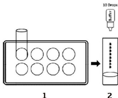
1. Inserte el tubo desechable en la estación de trabajo. Asegúrese de que el tubo esté estacionario y llegue al fondo de la estación de trabajo.
